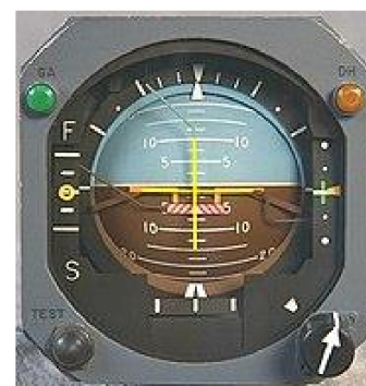
ADI (izquierda) con barras de dirección V amarillas y una IA integrada con pendiente de planeo ILS e indicadores de localizador (derecha)
