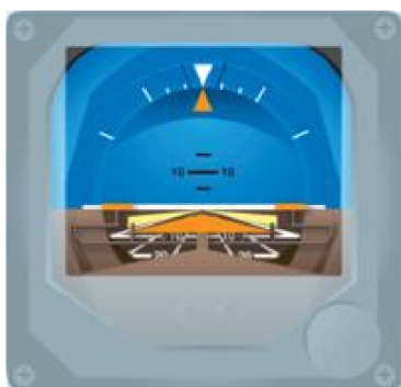
ADI (izquierda) con barras de dirección V amarillas y una IA integrada con pendiente de planeo ILS e indicadores de localizador (derecha)
