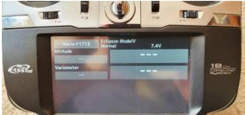
Si el avión está apagado veremos esa pantalla con guiones. En caso de tener el avión encendido veremos para cada sensor: en tamaño pequeño los valores mínimo y máximo registrados. Pulsando en esa casilla los pondremos a cero. En tamaño grande nos saldrá ya el valor actual del sensor. Pulsando sobre él (o sobre los guiones con el avión apagado) accedemos a la pantalla de ajustes de alarmas:
