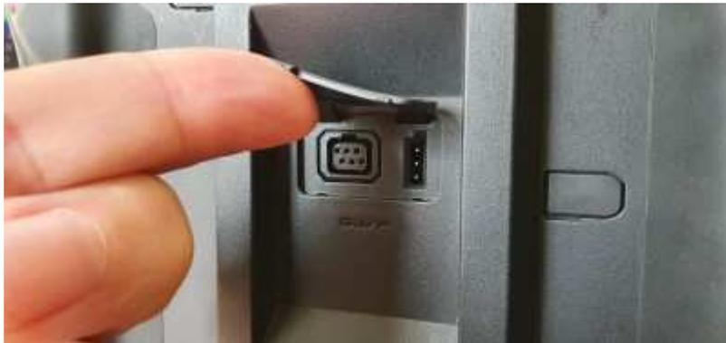
2.- Conectamos el módulo de sensores a ese puerto de la emisora. Casi todos los modelos son capaces de alimentar así al propio módulo, salvo la 14SG que necesitará un cable Y para alimentar con batería externa.
