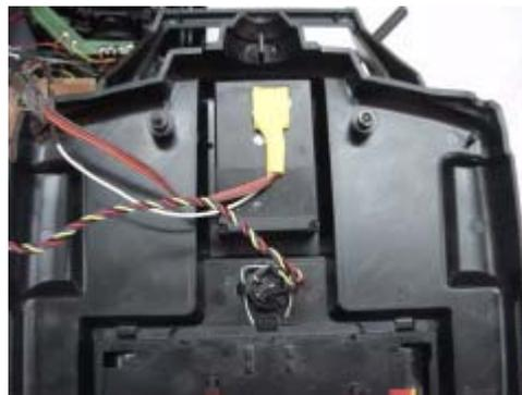
**A LA TAPA TRASERA** le hemos practicado un agujero para sacar la antena articulada, en la posición que queda el módulo se ve por el hueco del cuarzo el led del módulo de emisión lo cual es necesario ya que en caso de vinculación o malfuncionamiento nos da indicaciones.
