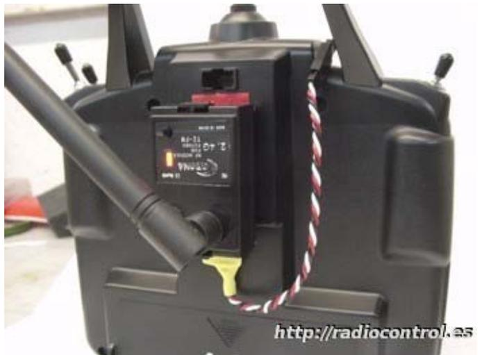
Hay que preparar un cable de adaptación entre el modulo y el conector que hemos instalado en la radio.
