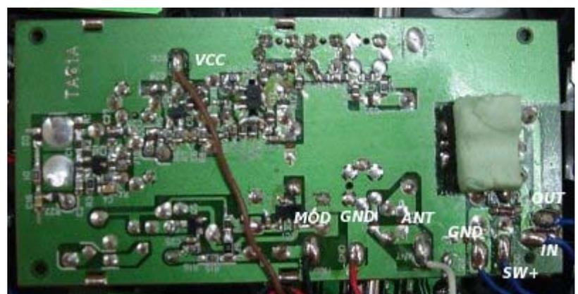
**CONOCIENDO EL CONEXIONADO** de estos cables en los módulos de emisión es fácil preparar un conector que lleve cada conductor a su destino.
