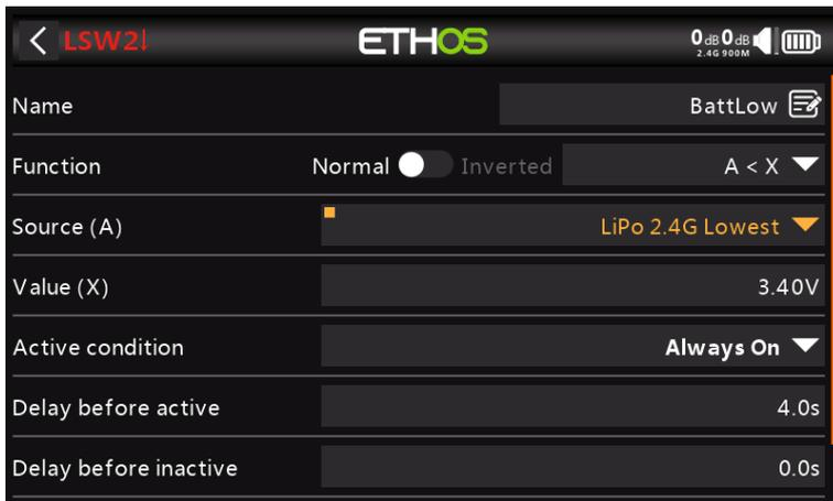
Establezca el valor en algo así como 3,4 V y 'Retraso antes de activar' en 4 segundos. El interruptor lógico se volverá verdadero/activo cuando el voltaje de celda más bajo permanezca por debajo de 3,4 por celda durante 4 segundos o más. Un umbral de 3,4 V bajo carga se recuperará a alrededor de 3,7 V cuando ya no esté bajo carga.
