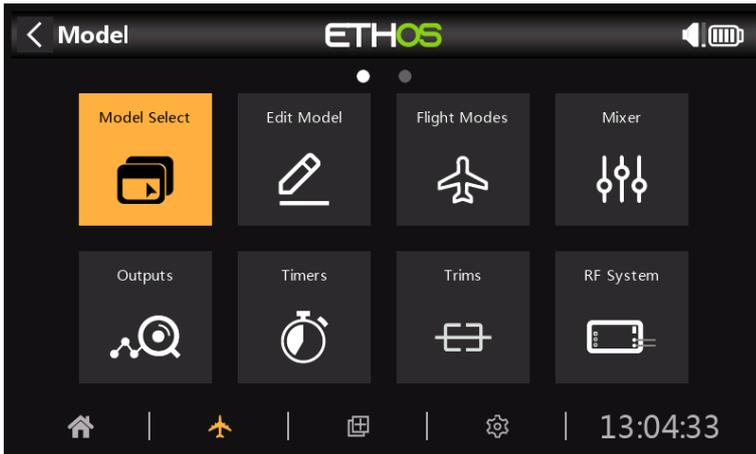
Se accede a la opción Selección de modelo seleccionando 'Selección de modelo' en el menú Modelo. Se utiliza para seleccionar el modelo actual, agregar un nuevo modelo o clonarlo o eliminarlo.
