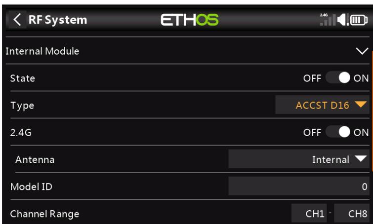
El modo ACCST D16 es para la transmisión dúplex completa bidireccional ACCST de 16 canales, también conocida como modo "X". Para usar con los receptores heredados de la serie "X".
