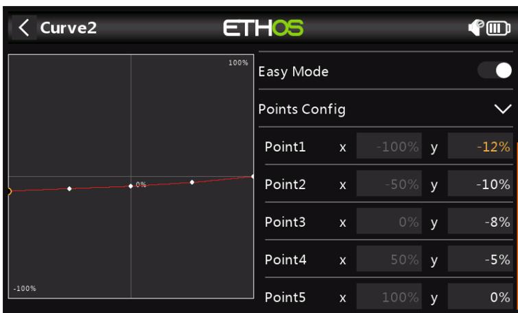
En este ejemplo EleComp tiene valores iniciales de -12%, -10%, -8%, -5% y 0%. Si su aeronave no tiene una curva de compensación de profundidad especificada, estos puntos deberán determinarse empíricamente.
