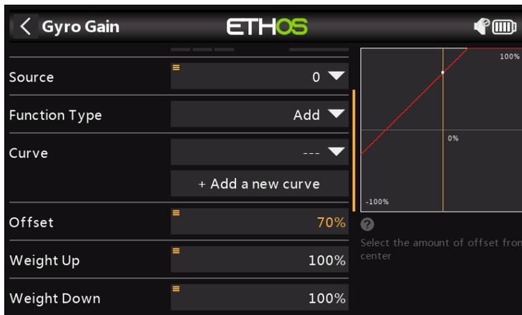
La ganancia del giroscopio suele ser un valor fijo, por lo que establecemos la Fuente en Valor especial: 0 y luego marcamos el valor de ganancia requerido usando Compensación. Es posible que sea necesario determinar el valor de ganancia final en vuelo. Asigne el canal de salida a 5.
