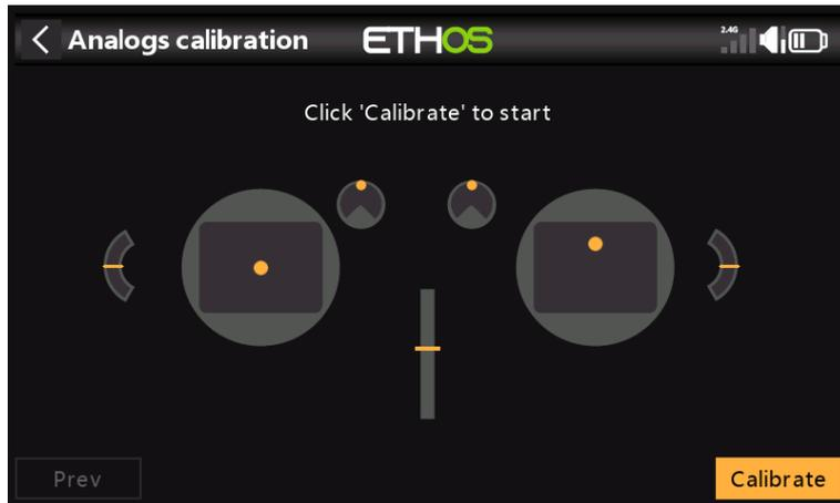
La calibración de los análogos se realiza para que la radio sepa exactamente dónde están los centros y los límites de cada cardán, potenciómetro y control deslizante. Se ejecuta automáticamente en el inicio inicial. Debe repetirse después de reemplazar un cardán, un potenciómetro o un deslizador.
