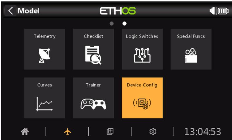
Device Config contiene herramientas para configurar dispositivos como sensores, receptores, el conjunto de gases, servos y transmisores de video.
