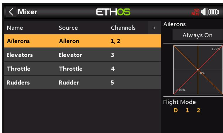
Si su modelo se creó utilizando uno de los asistentes de creación de modelos en la función 'Selección de modelo' en el menú Sistema, las líneas del mezclador base se mostrarán cuando toque el 'Mezclador'.
