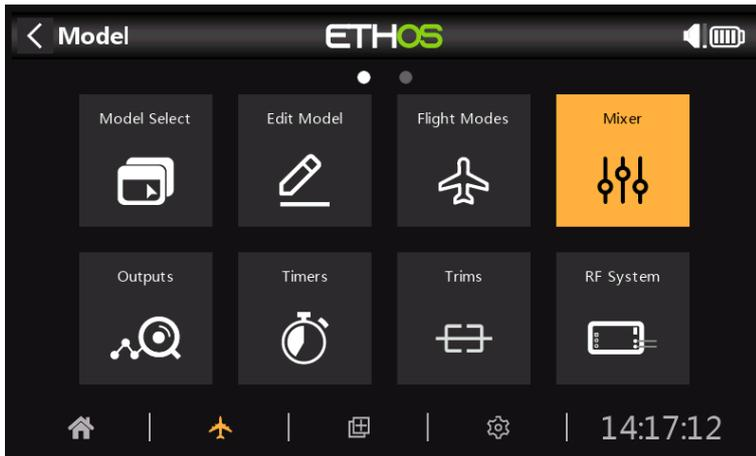
Toque el icono Mezclador para revisar las mezclas creadas por el asistente de Avión.
