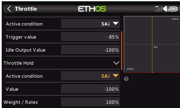
Throttle Hold se usa para apagar el motor en caso de emergencia desde cualquier posición del acelerador. Cuando se cumple la condición de Throttle Hold Active, la salida del acelerador se reduce instantáneamente a -100% (o el valor ingresado). Como se puede ver en el gráfico anterior, la salida del acelerador se ha reducido al -100 % a pesar de que la palanca del acelerador está por encima de la marca de la mitad).
