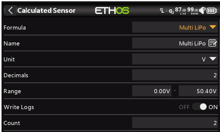
El sensor Multi Lipo permite que dos sensores lipo se conecten en cascada para monitorear lipos mayores a 6S.
