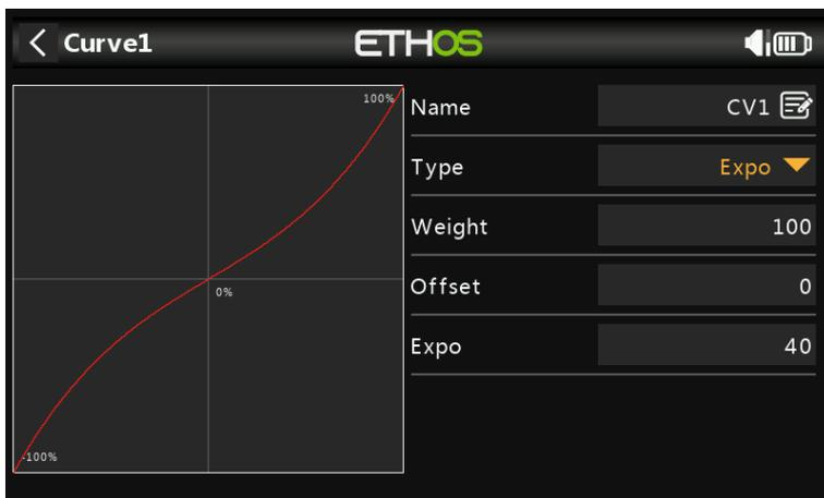
Un valor positivo suavizará la respuesta alrededor de 0, mientras que un valor negativo agudizará la respuesta alrededor de 0. Suavizar la respuesta alrededor de la palanca media ayuda a evitar el control excesivo del modelo, especialmente para los principiantes.
