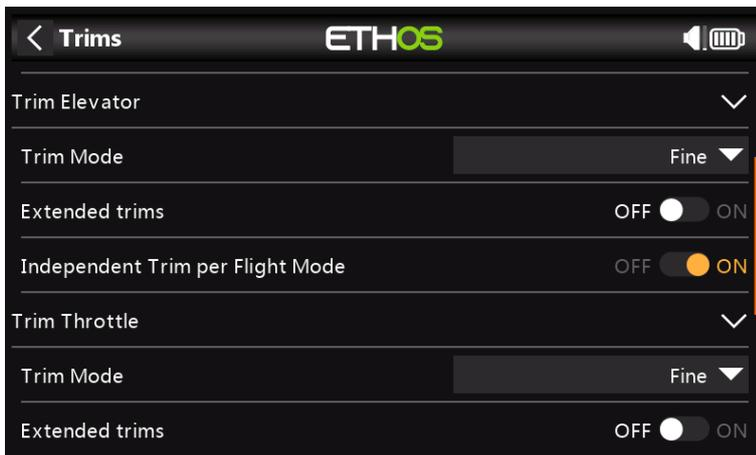
A continuación, vamos a la sección Trims y cambiamos la palanca del Elevador para que tenga Trims independientes por modo de vuelo. Esto le permite tener una compensación de profundidad independiente para los dos ajustes de flaps. El interruptor de compensación del elevador cambiará automáticamente entre las configuraciones a medida que opere las aletas en el interruptor SE.
