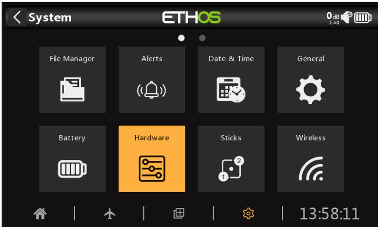
La sección Hardware se usa para probar todas las entradas, realizar una calibración analógica y giroscópica y establecer tipos de interruptores.
