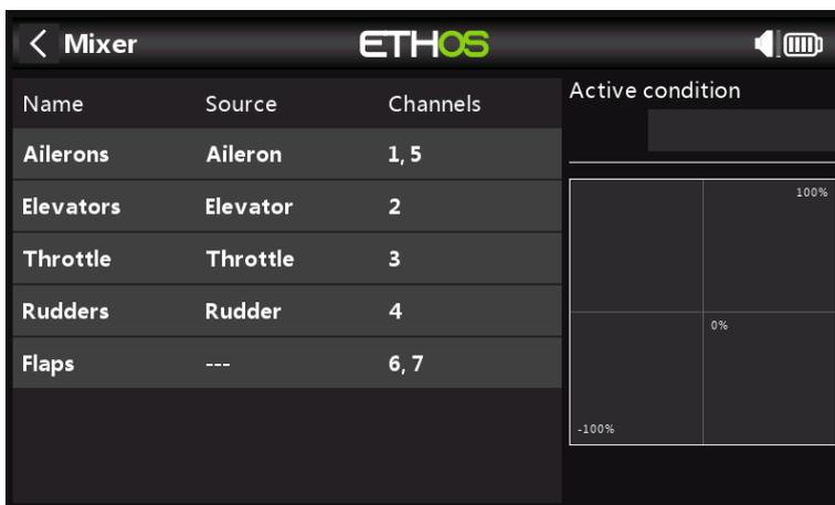
El asistente ha creado dos alerones en los canales 1 y 5, seguidos de los canales Elevator, Throttle, Rudder y Flaps.
