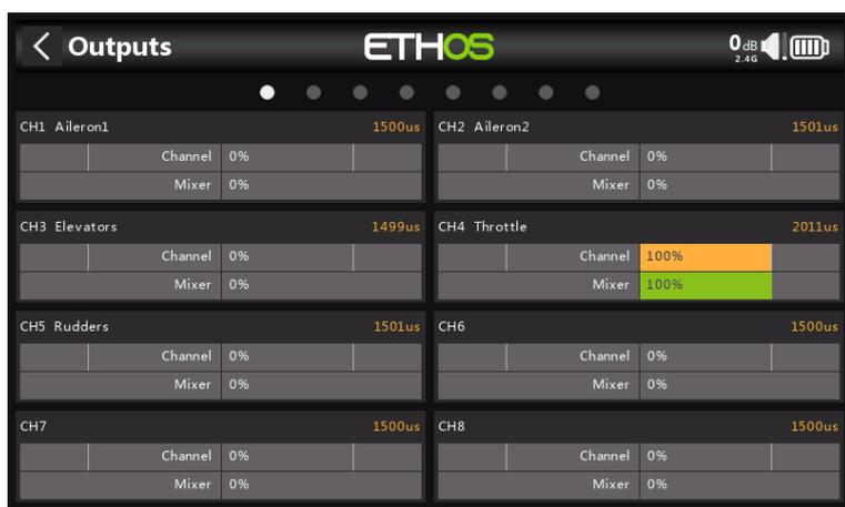
La pantalla Salidas muestra dos gráficos de barras para cada canal. La barra inferior (verde) muestra el valor del mezclador para el canal, mientras que la barra superior (naranja) muestra el valor real (tanto en términos de % como de  $\mu\text{s}$ ) de la salida después del procesamiento de las salidas, que es lo que se envía al receptor. En el ejemplo anterior, puede ver que tanto el mezclador como los valores de salida para CH4 Throttle están al 100%.
