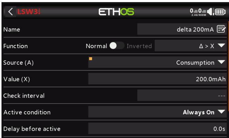
Agregue un nuevo interruptor lógico usando la función Delta (d>X) para monitorear el sensor de consumo y vuélvase verdadero/activo cada vez que el consumo alcance, digamos, 200 mAh, o una fracción conveniente de la capacidad de la batería.
