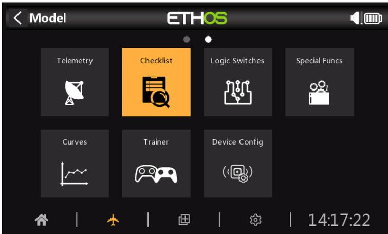
La función Lista de comprobación proporciona un conjunto de comprobaciones previas al vuelo. Este es un grupo de funciones de seguridad que tienen efecto cuando se enciende la radio y/o se carga un modelo de la lista de modelos.
