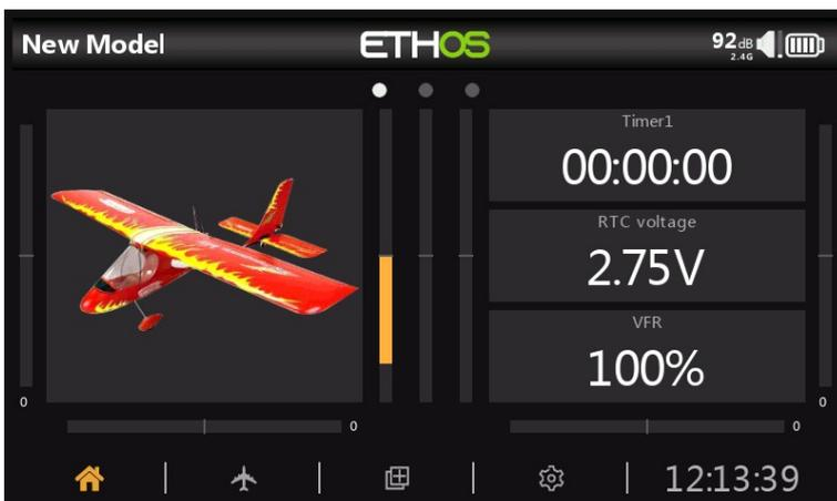
En el ejemplo anterior, el widget de mapa de bits del modelo muestra la imagen del modelo que se configuró en Modelo/Editar modelo/Imagen. El widget del medio a la derecha muestra el voltaje de la batería del reloj en tiempo real de la radio, mientras que el widget inferior muestra la velocidad de cuadro válida.
