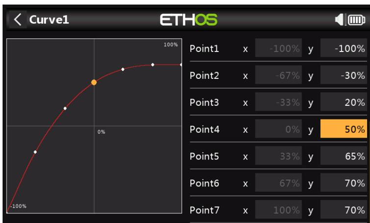
El modo normal se usa para enrollar y despegar, por lo que la curva comienza en -100 % (motor apagado) y luego aumenta suavemente para el despegue. Es posible que sea necesario determinar los valores finales de la curva en vuelo.
