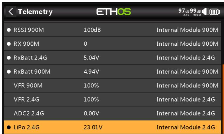
En Opciones de receptor, establezca el Puerto de telemetría en la opción S.Port. Conecte el FLVSS a su receptor a través de un cable S.Port y habilite la opción 'Descubrir nuevos sensores' en Modelo / Telemetría. El sensor LiPo adicional se muestra en el ejemplo anterior.
