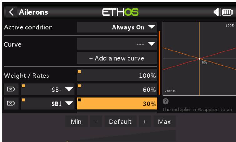
Haga clic en 'Agregar un nuevo peso' y configure una Tasa del 30% para el interruptor SB en la posición hacia abajo. El eje vertical en el gráfico de la derecha ahora muestra que solo el 30% del alcance está disponible en esta posición del interruptor.
