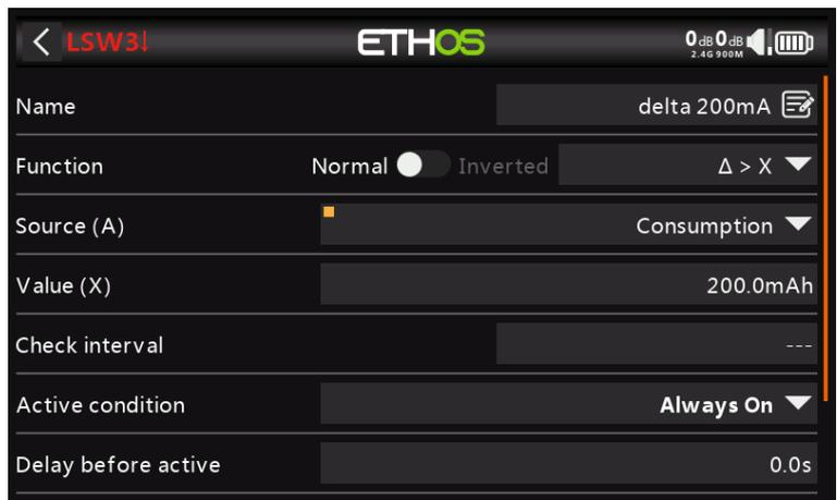
La condición es verdadera si el cambio en el valor 'd' (es decir, delta) de la fuente seleccionada 'A' es mayor o igual que el valor definido por el usuario 'X', dentro del 'Intervalo de verificación'. Si el 'Intervalo de verificación' se establece en '---', entonces el intervalo de verificación se vuelve infinito.
