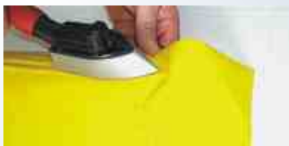
Fig. 9 / 9a Trabajar gradualmente en torno a las curvas
