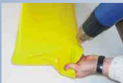
Fig. 11a-d Recubrimiento de la punta del ala
