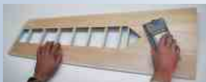
Fig. 2 Lijar uniformemente las superficies
