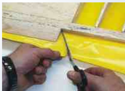
Fig. 12a Para las esquinas interiores, en primer lugar inclinar 45°.
