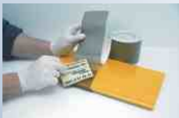
Aplice el film de enmascarado EASYPLOT ® con el Rascador ORACOVER ®, a fin de evitar burbujas.
