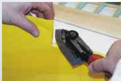
Fig. 12b Plegar y unir el recubrimiento.
